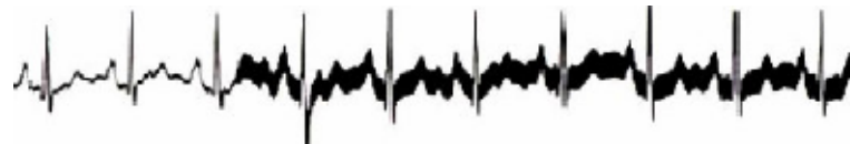
Figura No. 10 Interferencia de la Red Eléctrica
